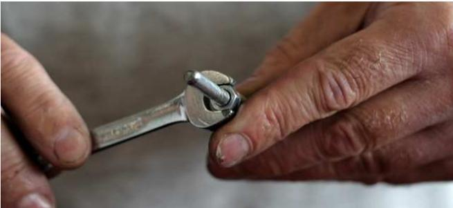
M5er Schrauben lösen und Pumpe wieder ausbauen; die Stehbolzen verbleiben im Lenker.
