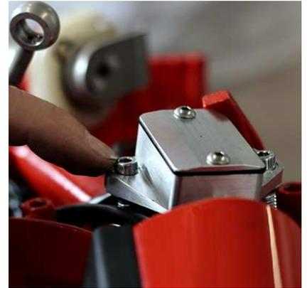
Anschließend zweite Mutter und Unterlegscheibe montieren. Danach die beiden M5er Schrauben nochmal kurz lockern, die Pumpe in Richtung Lenkermitte drücken und wieder festziehen, um ein späteres Verschieben zu vermeiden.
