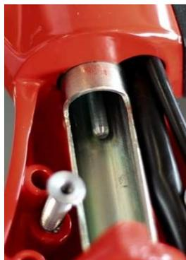
Gasrolle mit den original Distanz-/Wellscheiben montieren.
