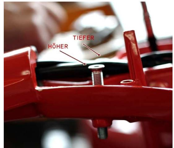
Die Pumpe einfädeln und mit der vorderen Schraube festziehen.
