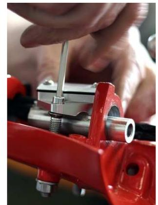
Anschließend kontrollieren, ob die Pumpe mittig in der Gasrohlagerung sitzt und gegebenenfalls Schraube und Stehbolzen lockern, verdrehen und wieder anziehen, bis die Höhe passt.
