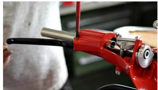
Bremsschlauch montieren und wie gewohnt Entlüften – Geduld und Schräglage sind von Vorteil.
