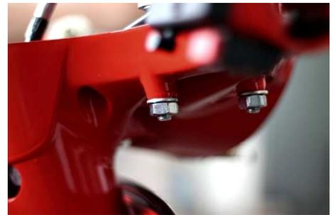
Bei der Druckstange die Mutter lockern und mit dem runden Ende voraus durch den Lenker in die Pumpe stecken. Hebel provisorisch montieren, dabei auf die korrekte Verbindung vom Hebel zur Druckstange achten – wie im Bild zu sehen.
