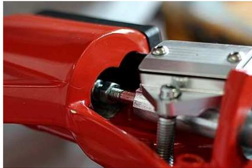
Hebel und Druckstange vorsichtig wieder ausbauen und mit der Mutter in der Länge fixieren.
